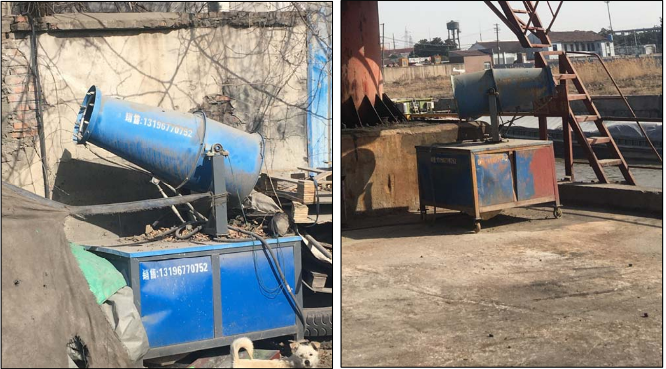
图 5.2-2 码头处已设置 2 台移动式雾炮机
