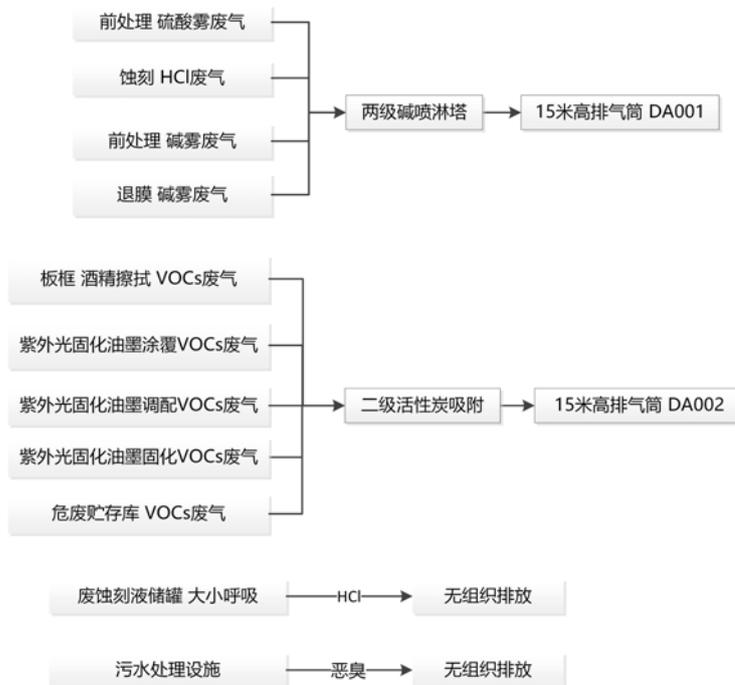
图 2.3-7 废气处理系统流程图
