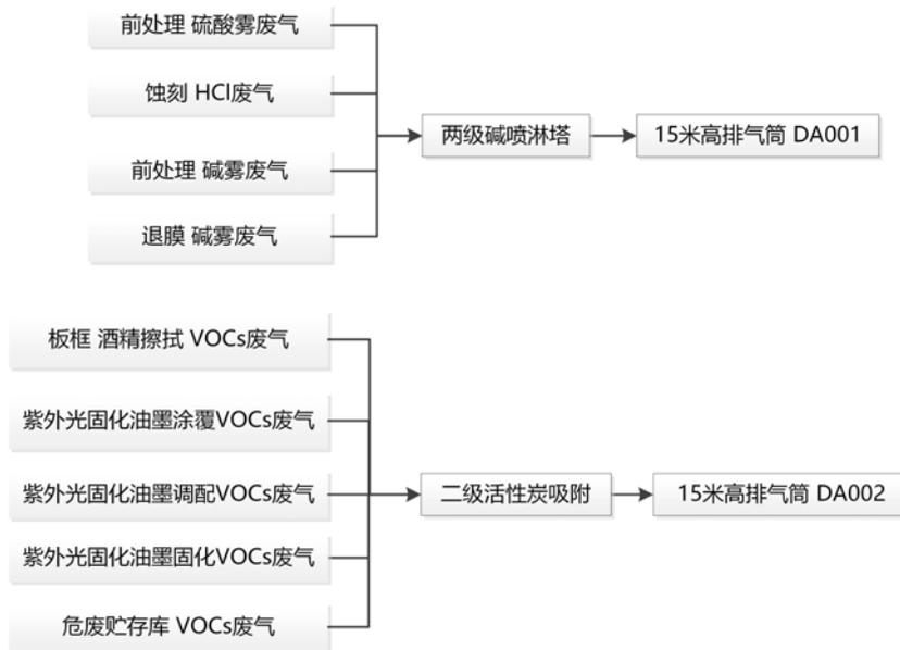
图 4.1-2 本项目实施后全厂废气处理收集及处理流程图
