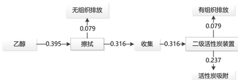
图 2.2-9 本项目 VOCs 平衡图 单位: t/a
